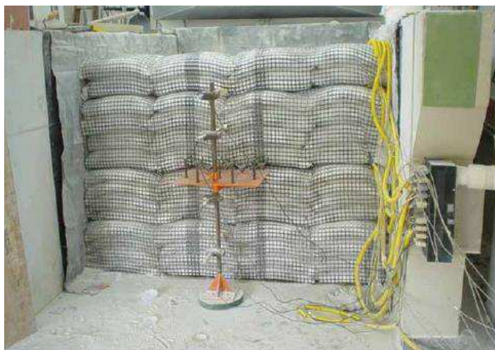
Figura 22 - Modelo físico de MSR com face formada por sacos de areia.
