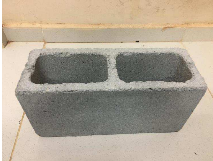
Figura 36 - Bloco de concreto utilizado para construção da face do modelo físico.
