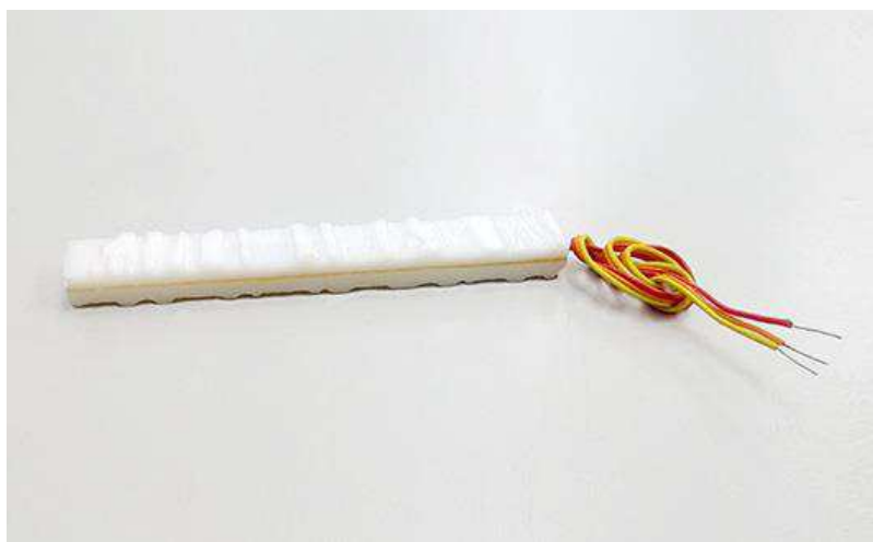
Figura 39 - Extensômetro utilizado no modelo físico de solo reforçado.
