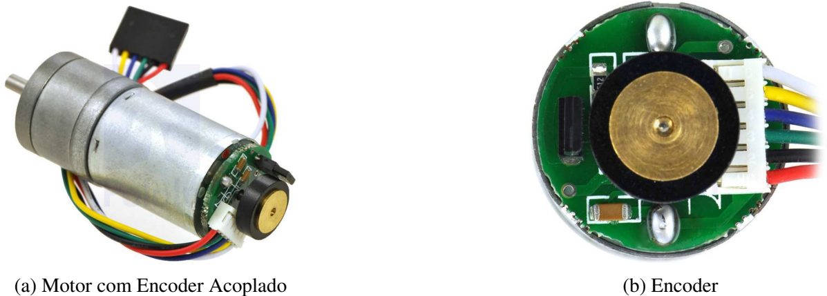
Figura 14: Motor 34:1 Metal 25Dx52L mm HP 6V com Encoder 48 CPR de quadratura
