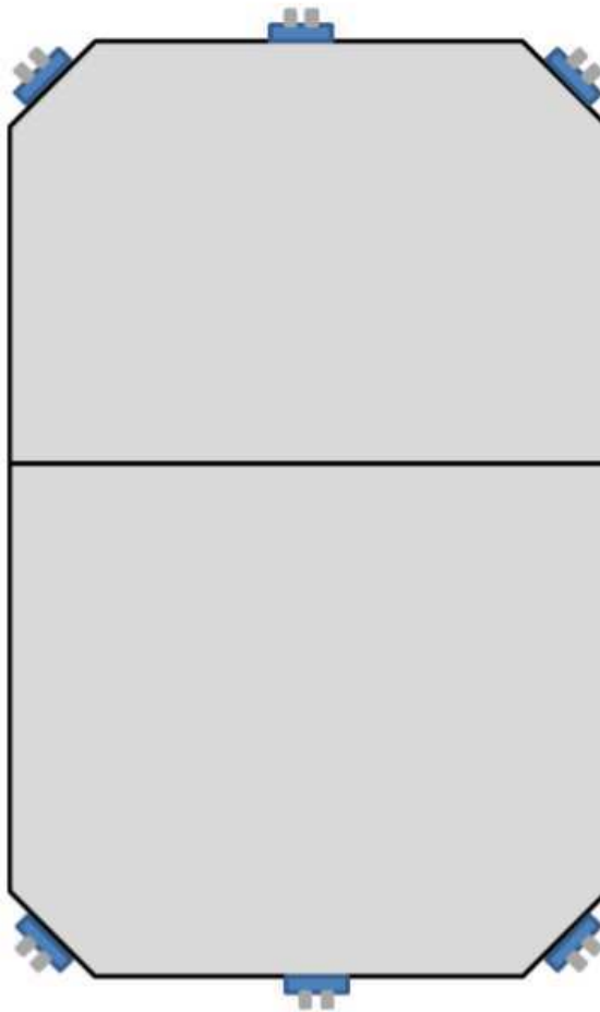
Figura 19: Disposição dos sensores de Ultrassom ao redor do veículo
