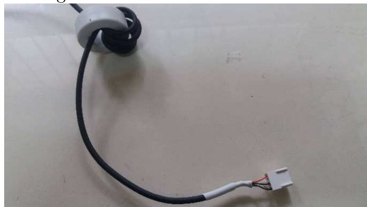
Figura 22: Cabo blindado com filtro.
