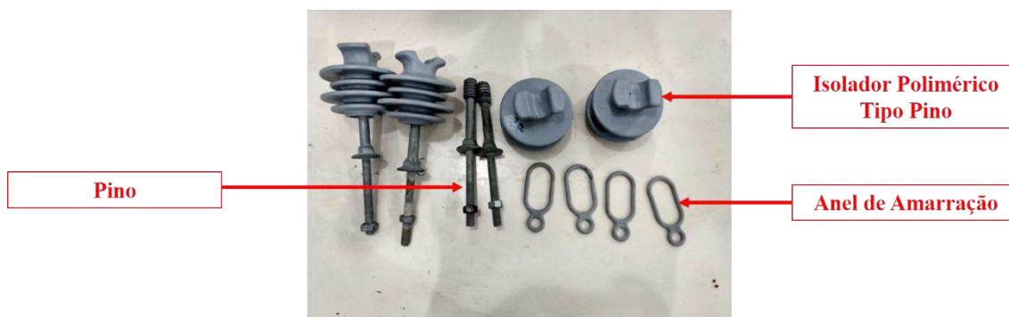
Figura 22 - Componentes Utilizados nos Ensaio de Tensão Suportável.
