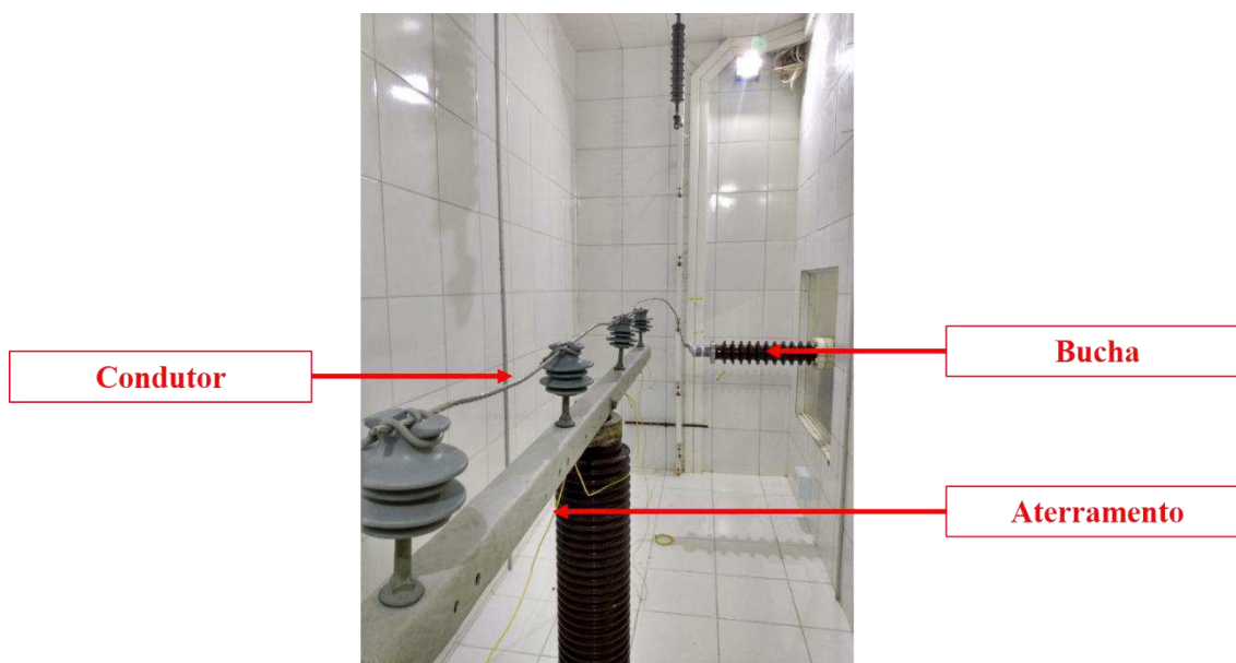
Figura 23 - Arranjo para Ensaio de Tensão Suportável de Isoladores Poliméricos.
