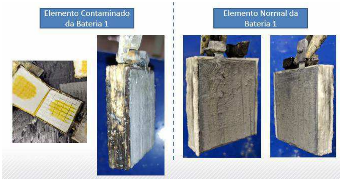
Figura 26: Elemento contaminado e elemento normal
