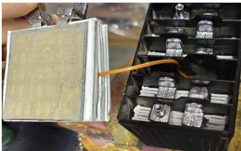
Figura 22: Sonda de temperatura inserida no meio das placas
