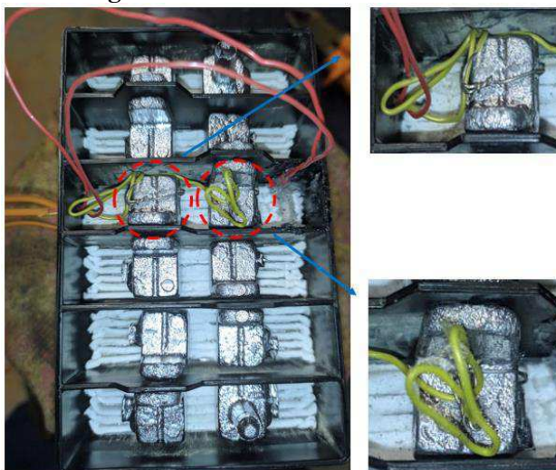
Figura 20: Detalhes das Conexões
