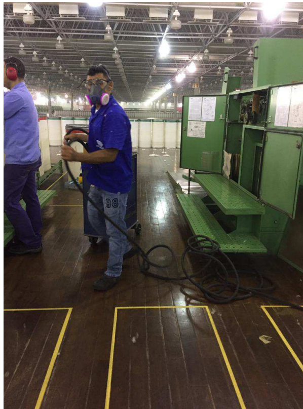
Figura 5 - Procedimento de limpeza de um passador.
