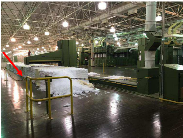
Figura 27 - Instalação de barreiras que impedem avanço na área de trabalho da Unifloc.
