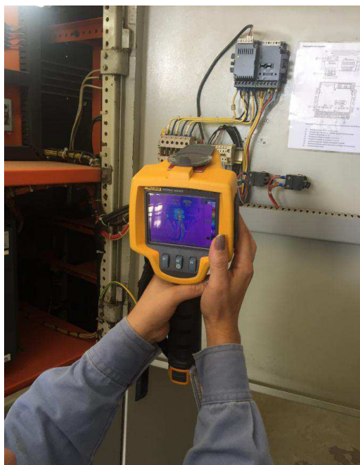
Figura 6 - Procedimento de análise termográfica.
