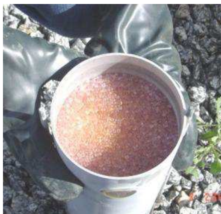
Figura 14 - Situação da sílica saturada no desumidificador.
