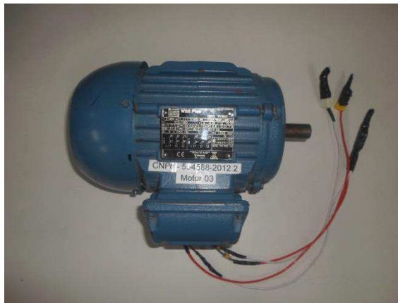
Figura 36: Motor bifásico utilizado
