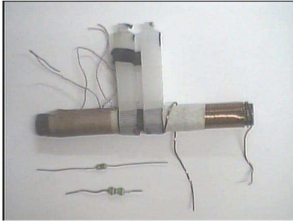
Figura 4.8: Indutores ôhmicos comerciais e indutor de núcleo de ferrite.
