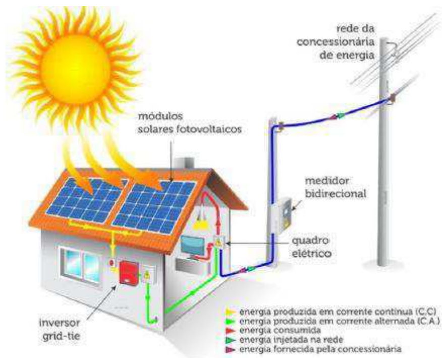
Figura 11 - Representação de um sistema conectado à rede
