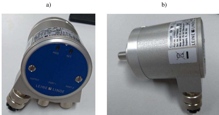
Figura 43: Encoder Leine Linde 608; a) vista frontal; b) vista lateral.
