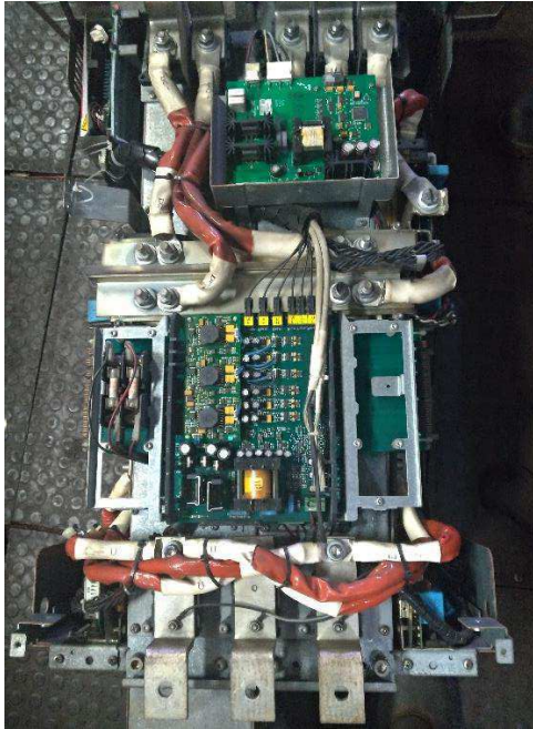
Figura 27: Inversor PowerFlex 700S sem tampas de proteção, a) vista superior, b) vista lateral.
