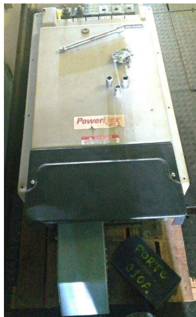
Figura 26: Inversor PowerFlex 700S novo.
