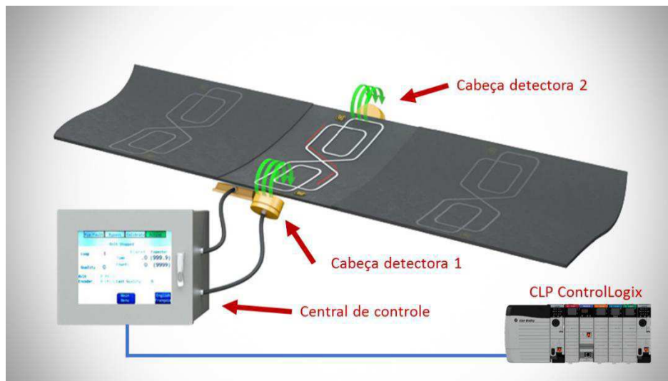
Figura 31: Princípio de funcionamento sistema RipProtect .
