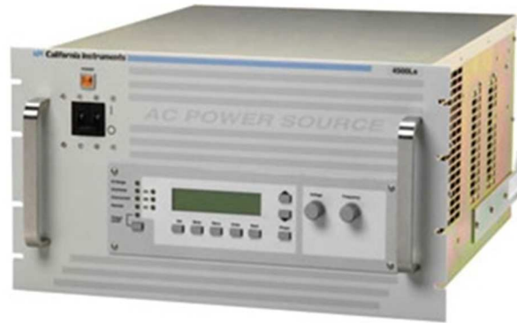
Figura 39 – Fotografia da fonte de alimentação programável AC da California Instruments ®.
