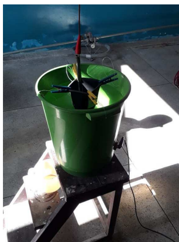
Figura 26 – Fotografia do ensaio em luvas isolantes.
