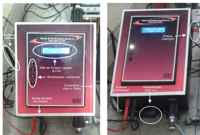
Figura 33 – Fotografia do sistema de monitoramento de para-raios de ZnO desenvolvido no LAT.
