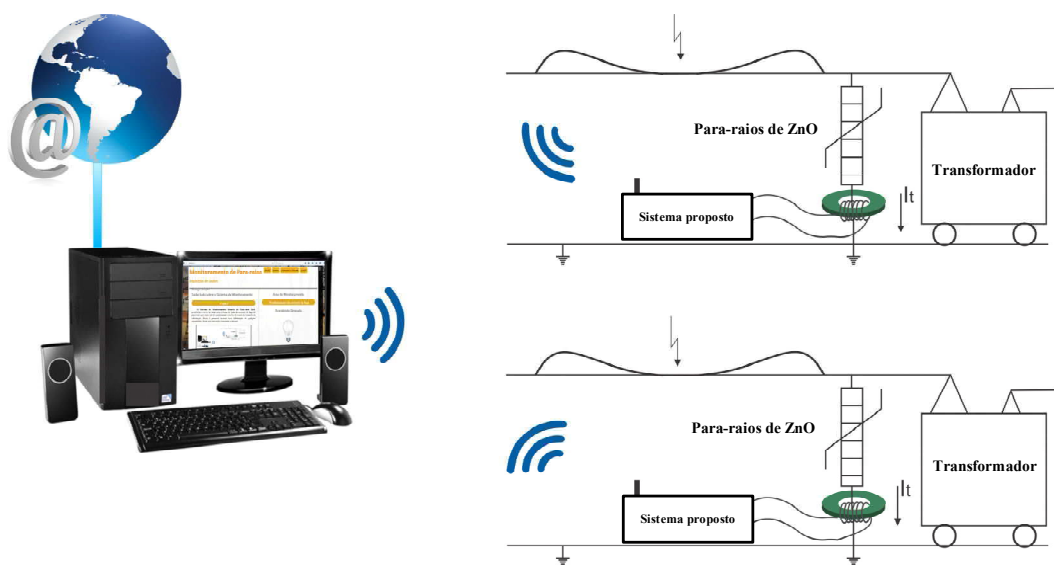
Figura 34 – Diagrama esquemático de funcionamento do sistema de monitoramento e diagnóstico de para-raios de ZnO desenvolvido no LAT.
