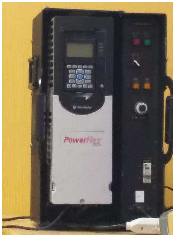
Figura 7 - Bancada de treinamento utilizando o PowerFlex 753 .
