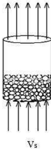
Figura 2.10: Reator adiabático de leito fixo.
