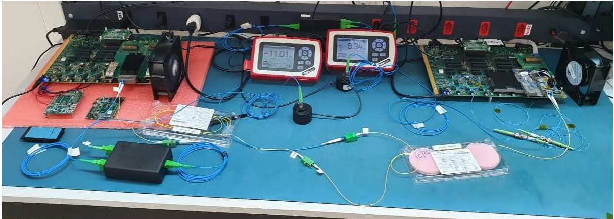
Figura 23 – Bancada de Testes com Módulos Ópticos
