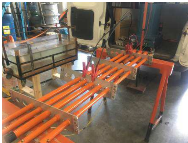
Figura 11 – Ensaio elétrico de isolamento
