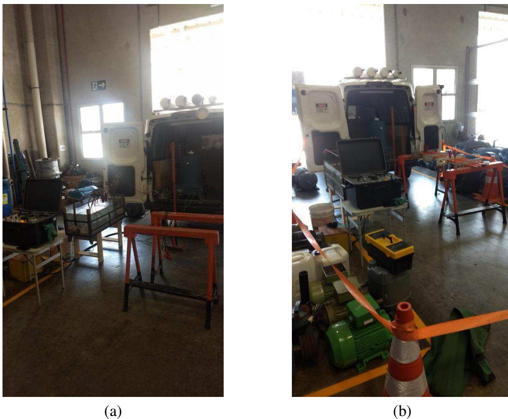
Figura 20 - Testes de isolamento em: (a) aterramento temporário; (b) varas de manobra.
