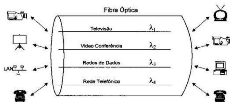
Figura 3 – Exemplo de divisão em um sistema de comunicação utilizando WDM
