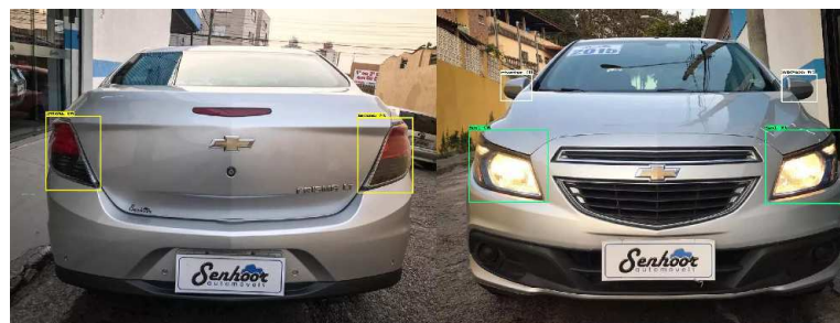
Figura 37 – Componentes detectados a partir das fotos do veículo, lanternas em amarelo, faróis em verde e retrovisores em branco.
