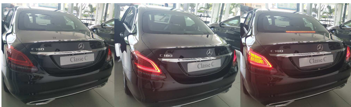
Figura 23 – Fotografias de um mesmo veículo nos estados desligado, à esquerda, lanterna ligada, ao centro, e freio acionado, à direita.
