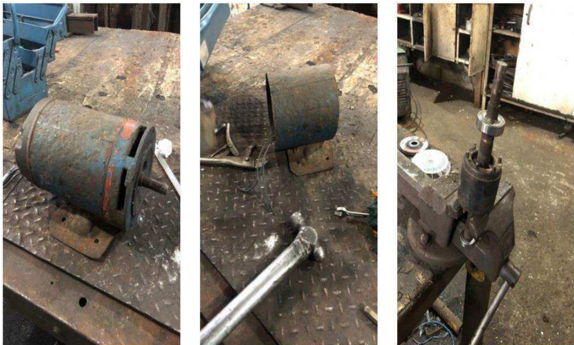
Figura 18: Troca dos rolamentos de um motor. Fonte: Autoria própria
