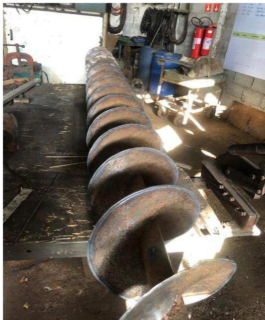
Figura 44: Rosca na oficina para manutenção Fonte: Autoria própria
