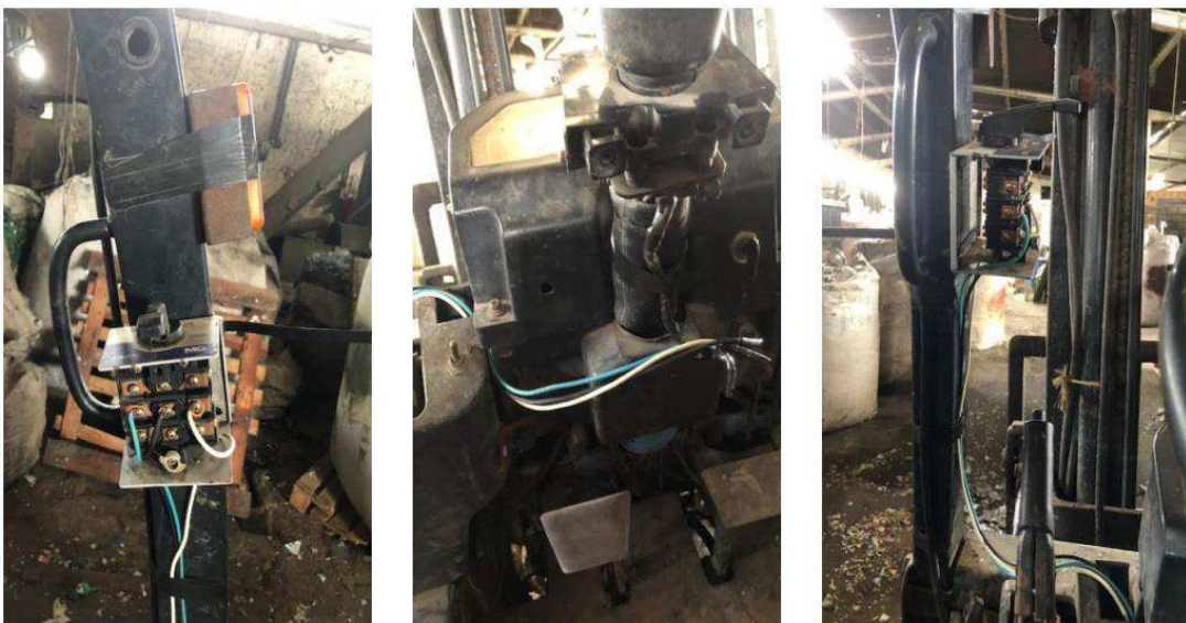
Figura 38: Chave reversora adaptada para a função de uma chave frente/ré Fonte: Autoria própria
