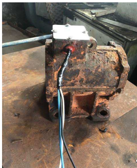
Figura 48: Estator após a realização da conexão Fonte: Autoria própria
