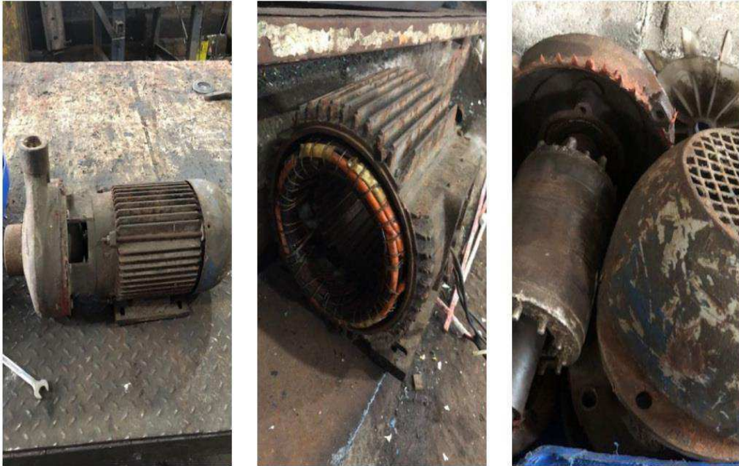
Figura 19: Desmontagem de um motor para rebobinamento. Fonte: Autoria própria
