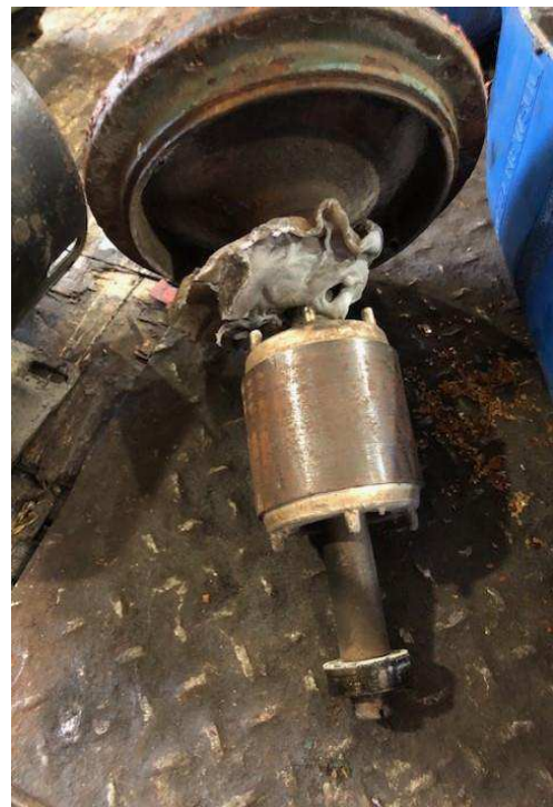
Figura 28: Rotor e ventoinha carbonizados Fonte: Autoria própria
