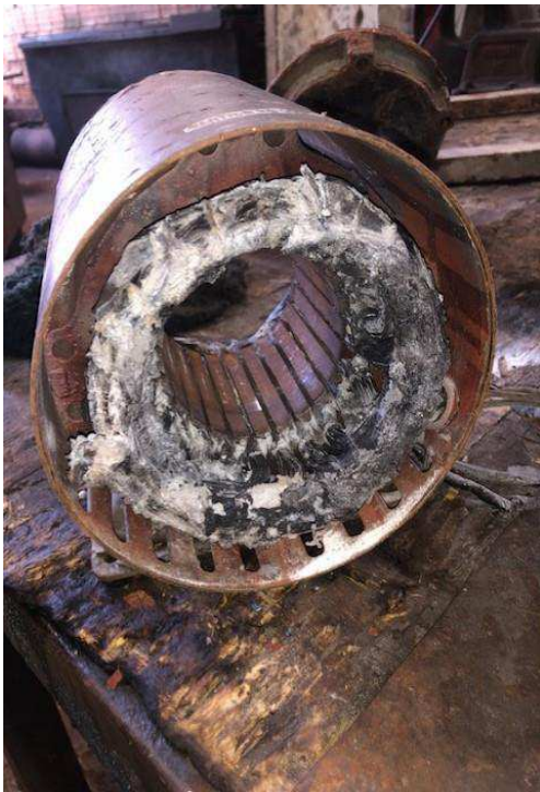
Figura 27: Estator da bomba d'água carbonizado Fonte: Autoria própria
