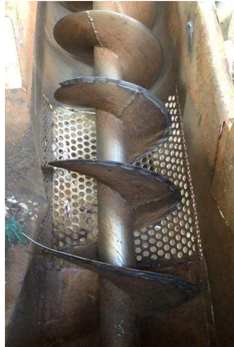
Figura 26: Camada de aço soldada à rosca. Fonte: Autoria própria
