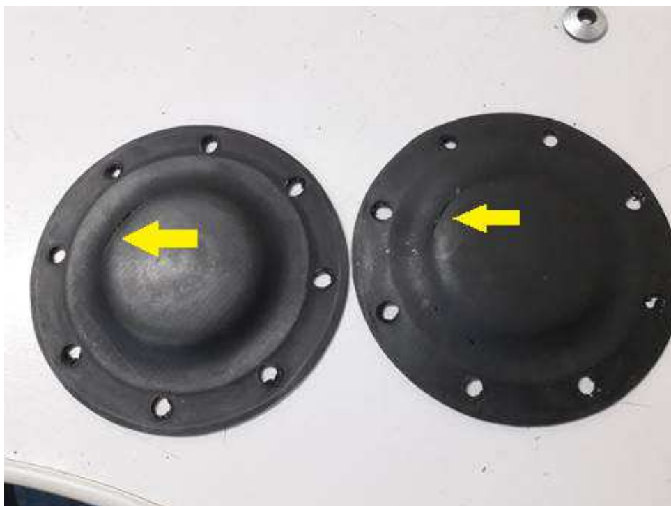
Figura 7 – Diafragmas dos atuadores que foram substituídos
