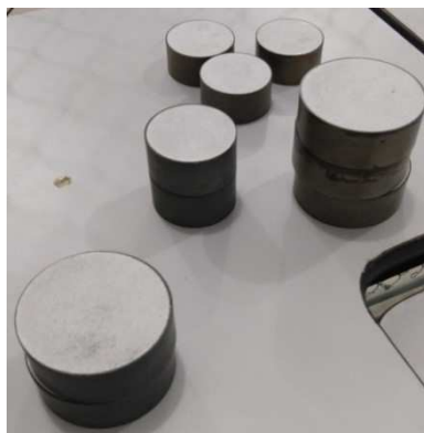
Figura 11 - Fotografia dos varistores de ZnO do LAT
