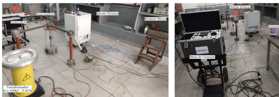
Figura 13 - Montagem utilizada no ensaio de envelhecimento dos varistores.
