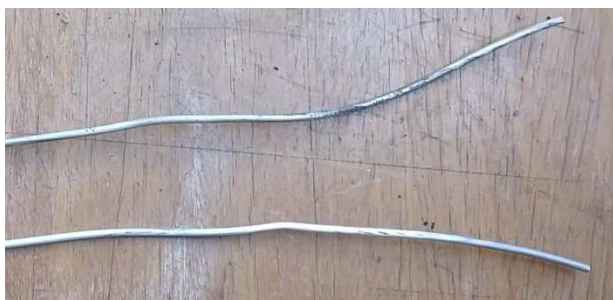
Figura 7 - Fios de alumínio antes e após a limpeza.
