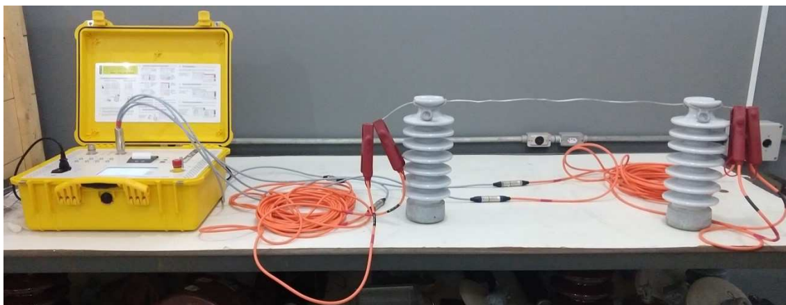
Figura 9 - Montagem do ensaio utilizado para medição da resistência elétrica.
