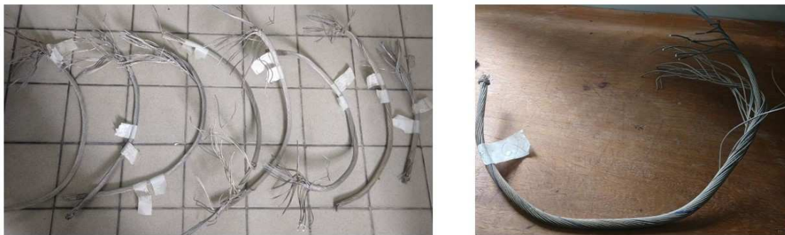
Figura 5 - Cabos aprovados na inspeção visual (esquerda) e a amostra reprovada nº06 (direita).
