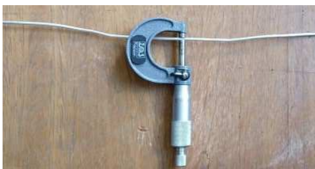
Figura 8 - Medição do fio de alumínio utilizando o micrômetro.
