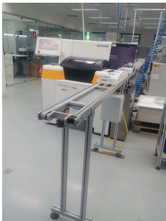
(a) Blocos oftálmicos entrando no Gerador
