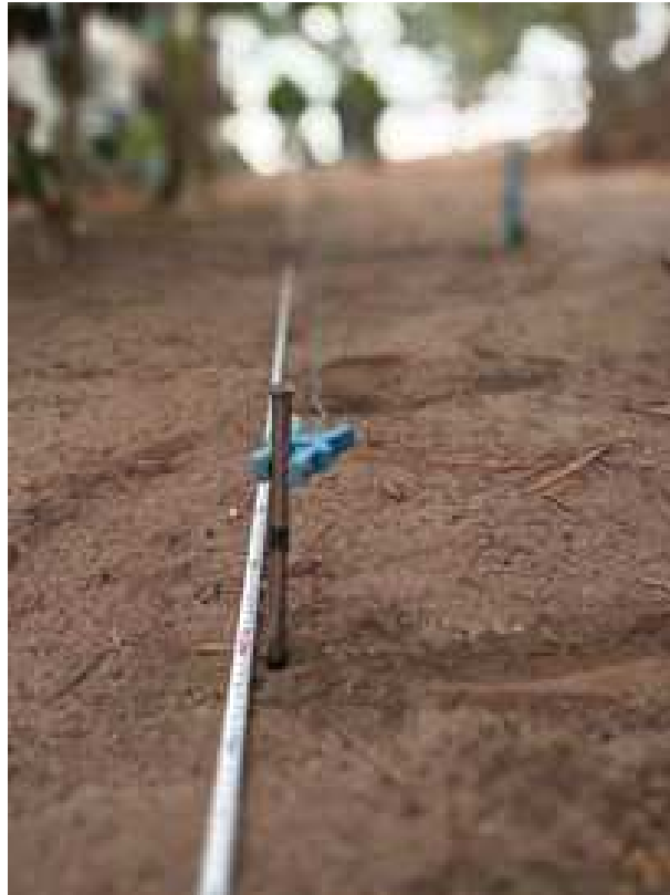
Figura 21: Haste fincada na terra.
