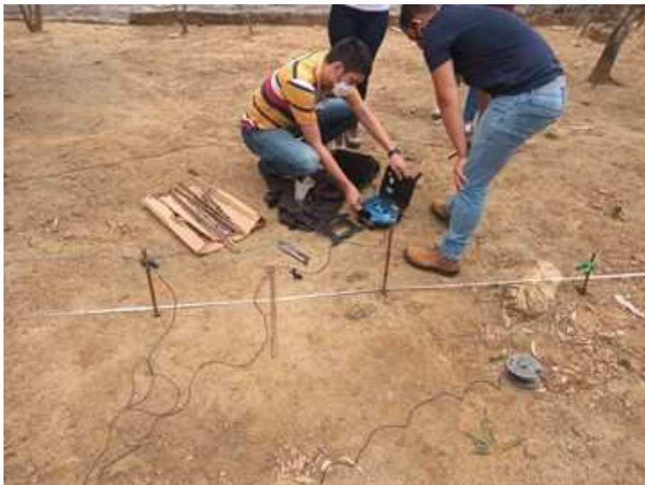
Figura 18: Medição da resistência.
