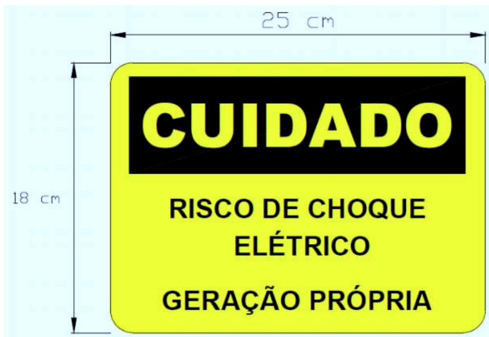
Figura 2.7 – Ilustração de placa de advertência (padrão Energisa).
