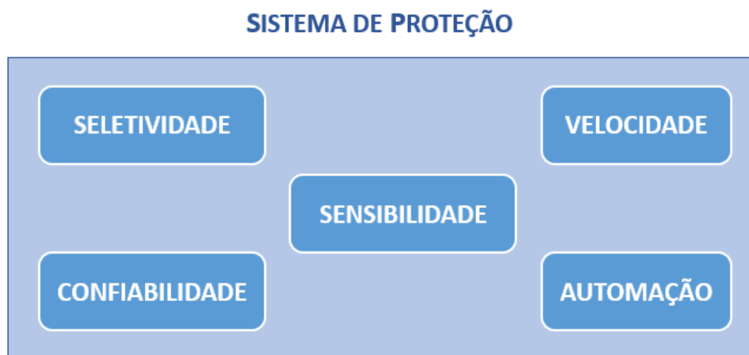
Figura 2: Requisitos básicos de um sistema de proteção.
