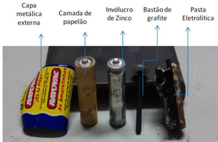
Figura 9 – Pilha desmontada
