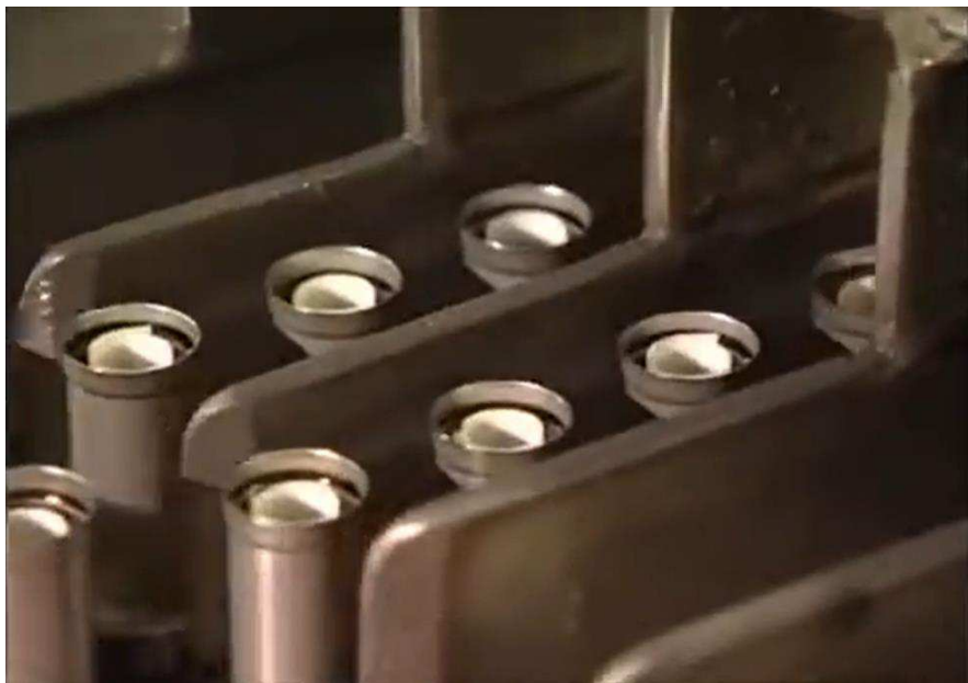
Figura 8 – Invólucros de aço com separador em processamento
