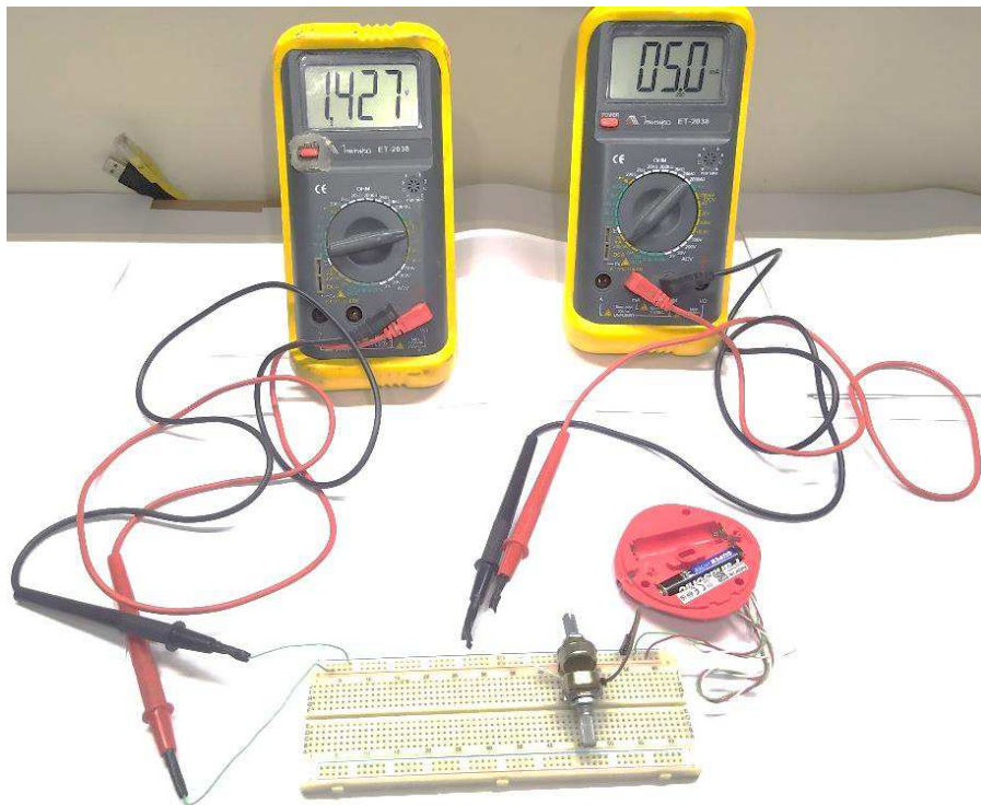
Figura 16 – Circuito de identificação da resistência interna montado em protoboard
