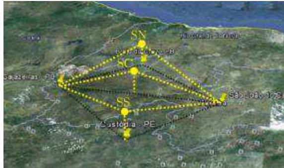
Figura 4.11 Ilustração dos setores de observação norte, sul e central. As linhas amarelas representam as linhas de visão de interferômetros e as linhas pretas representam as projeções das linhas amarelas.
