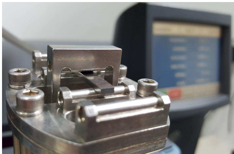
Figura 25. Montagem do Cp Longitudinal no analisador dinâmico mecânico Q800 da TA Instruments no modo de flexão em 3-pontos.
