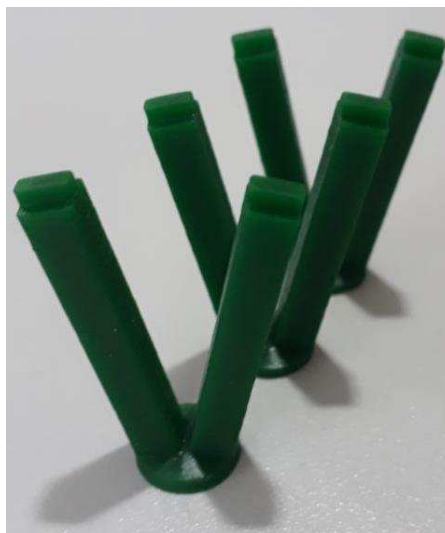
Figura 22. Modelo do lingote em formato de “V” em resina fotopolimerizada.
