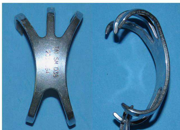
Figura 11. Fixador ortopédico do tipo patellar concentrator de LMF Ni-Ti. ( Memory alloy patellar concentrator ® , SEEMINE, Ltd., Lanzhou, CN)
