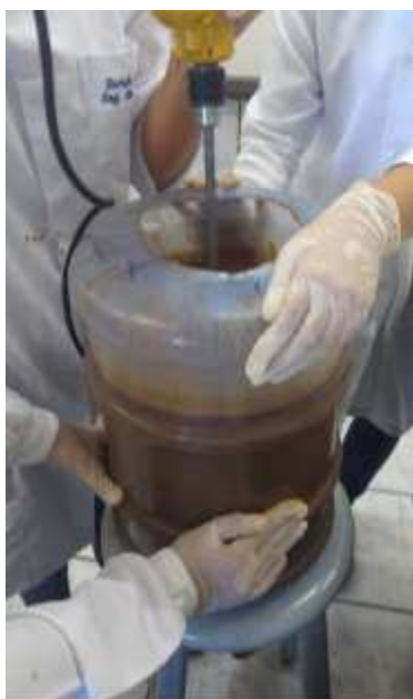
Figura 2 - Processo de homogeneização do fluido sintético olefínico
