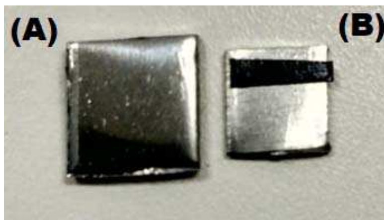
Figura 19 – Porta-amostras metálicos sem fita de carbono para coleta de amostras de fibras alinhadas para tratamento térmico e depois ensaio em MEV (A); porta-amostras metálicos
