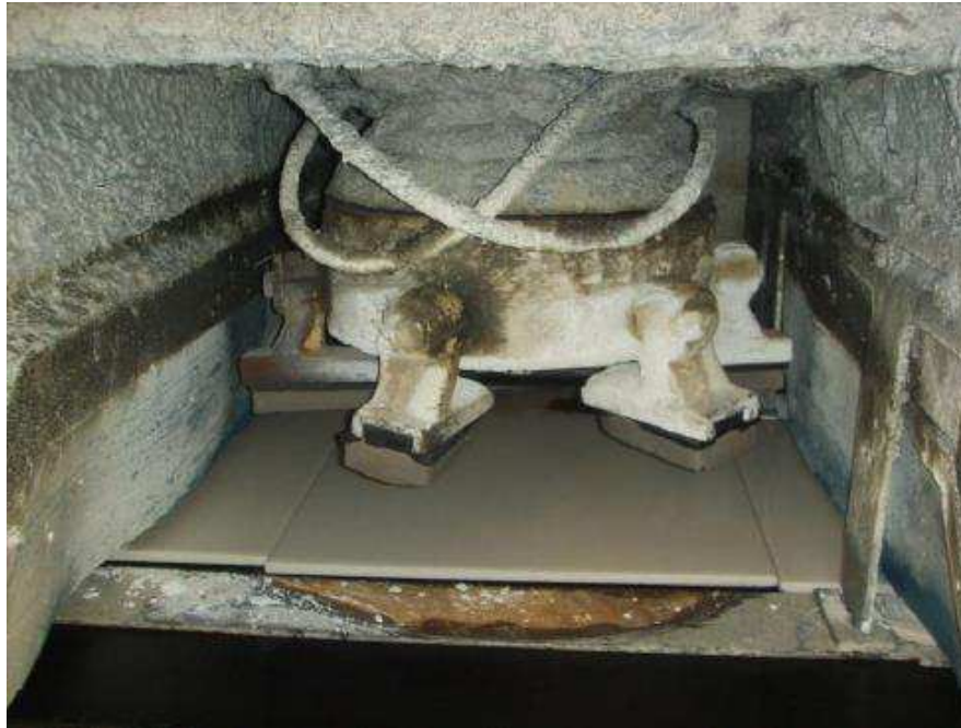
Figura 6 – Ferramenta de polimento com tijolos abrasivos (Souza, 2007).
