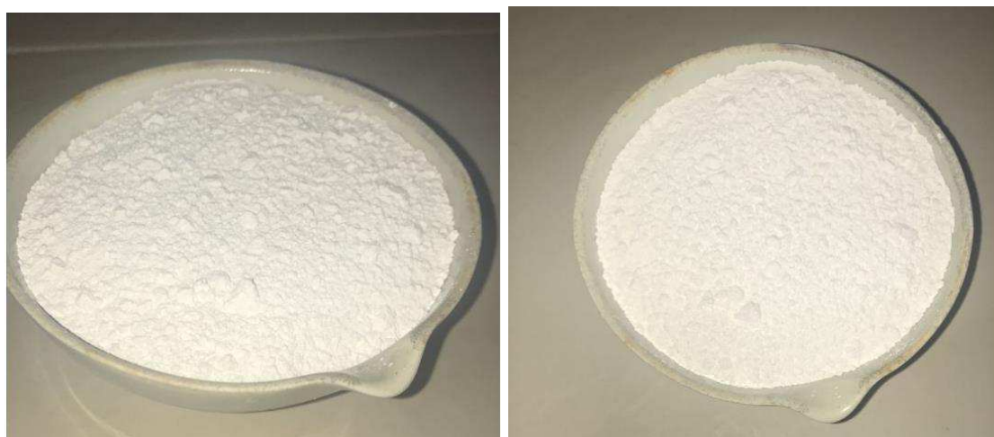
Figura 4 – Diópsido beneficiado em peneira ABNT Nº 200 (abertura 74 µm).
