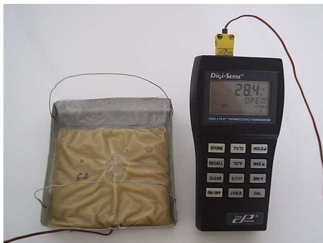
Figura 3.4 – Procedimento de determinação da cinética de congelamento realizada na amostra de umbuzada (cesta de arame, termopar e medidor de temperatura)
