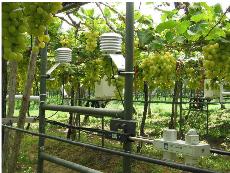
Figura 3.1. Imagem da localização dos sensores meteorológicos na altura dos cachos nas unidades experimentais de uva Itália Muscat.
