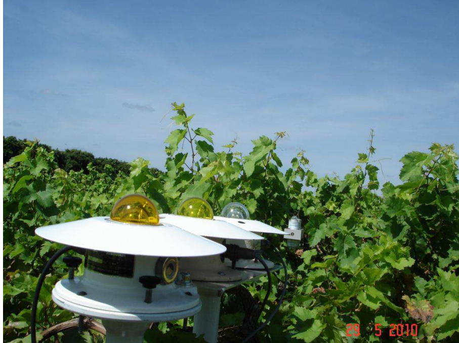
Figura 3.2. Imagem da localização dos piranômetros espectrais com filtros solares e net radiômetro posicionados acima do dossel descoberto para a avaliação da transmitância e dos fluxos radiativos.
