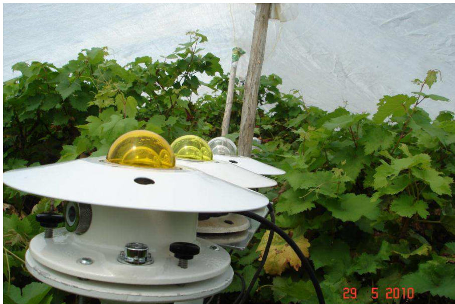
Figura 3.3. Imagem da localização dos piranômetros espectrais com filtros solares sob a cobertura plástica dos parreirais para a avaliação da transmitância.
