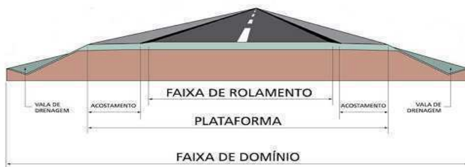
Figura 1: Desenho de caráter ilustrativo mostrando as características técnicas da rodovia BR-230 Fonte: Adaptado de DNIT (2009)
