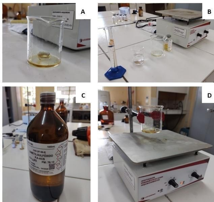
Figura 9. Processo de diluição com auxílio do DMSO. (A) Becker com amostra e imã; (B) Proveta com DMSO, Becker com água, Becker amostra e agitador magnético; (C) Recipiente do DMSO; (D) Agitador magnético em uso.
