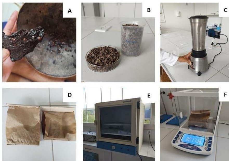
Figura 6. (A) Retirada das sementes da polpa; (B) Semente secas ao sol; (C) Trituração das sementes; (D) Sementes trituradas em saco de papel para secagem na estufa; (E) Estufa usada; (F) Pesagem das sementes trituradas para checagem de peso constante.
