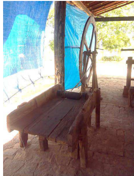
Figura 24 - Bancada de sevar e rodête (na extremidade da mesa onde estão conectadas as cordas). Museu Auta Pinheiro, Santa Cruz-RN. Acervo pessoal.
