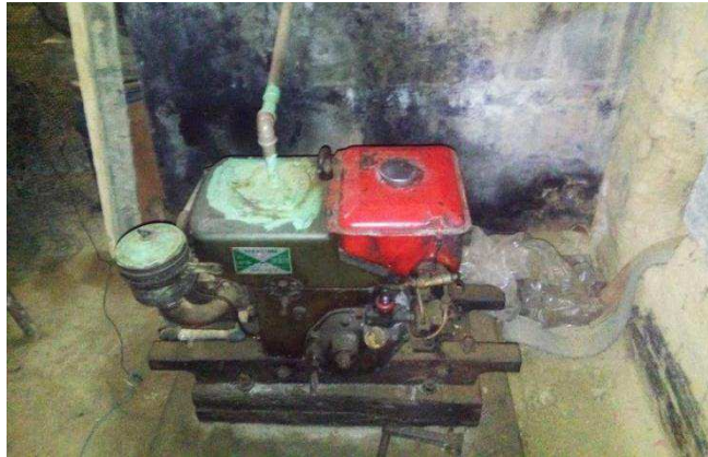
Figura 28 - Motor a óleo diesel no "quarto do motor". Acervo pessoal.
