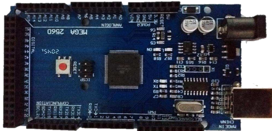
Figura 2 – Placa de prototipagem eletrônica e desenvolvimento livre Arduino MEGA 2560.
