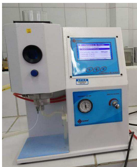
Figura 11. Fotômetro de chama QUIMIS Q498M.
