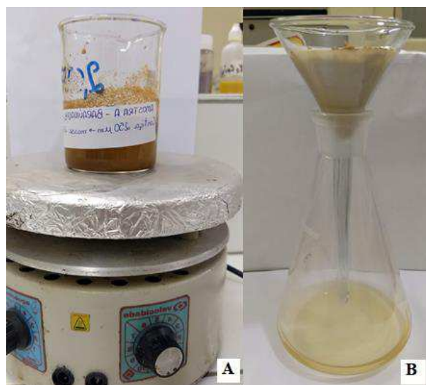
Figura 16. (A) Processo de agitação magnética. (B) Processo de adsorção por filtração.
