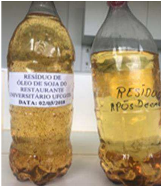
Figura 5. Processo de decantação natural do óleo residual.
