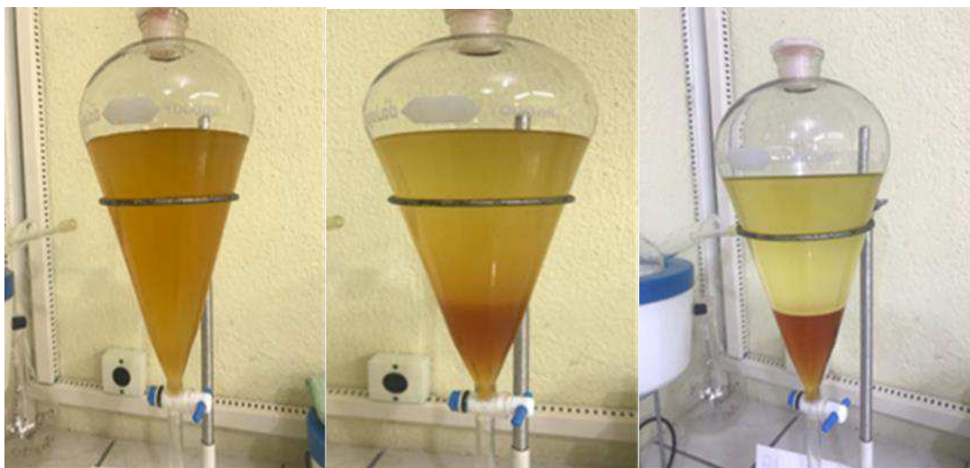
Figura 7. Processo de separação de fases dos ésteres metílico e etílico.
