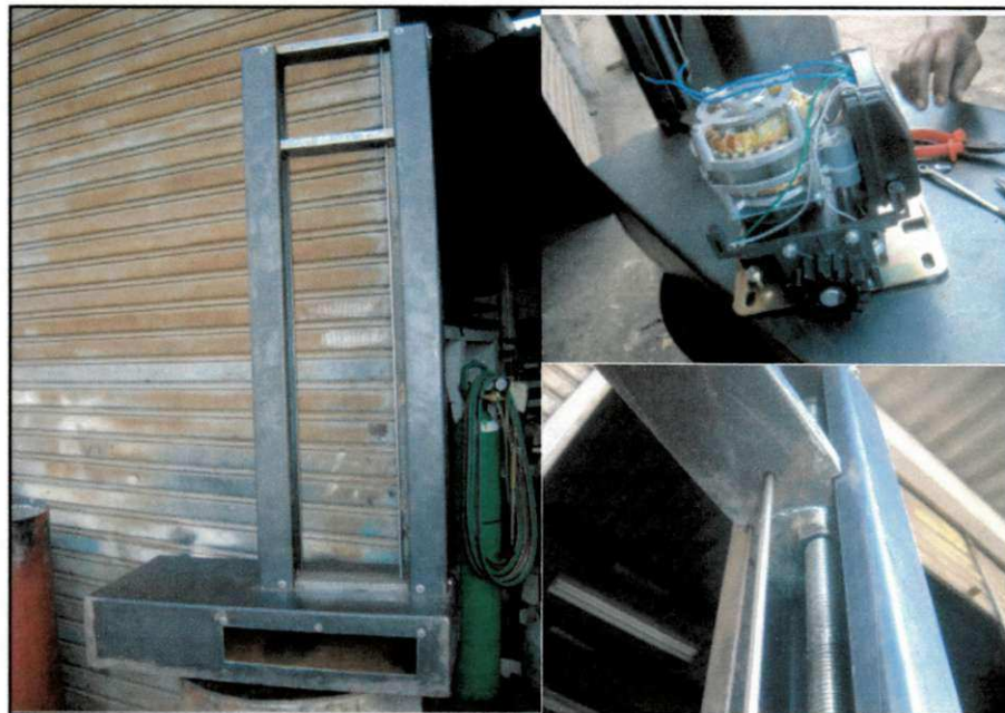
Figura 16 - Equipamento nas Etapas Iniciais de Produção. No canto superior direito, motor utilizado no projeto, no inferior direito, detalhe do parafuso sem fim.
