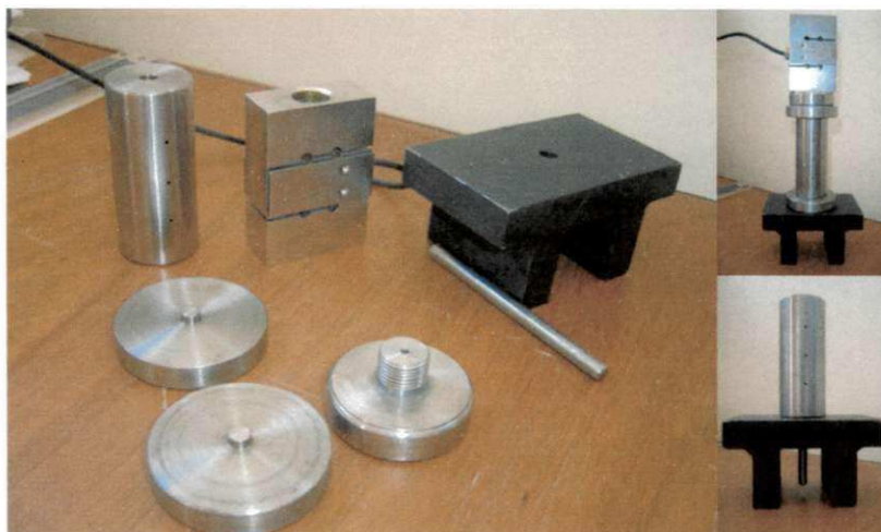
Figura 21 - Peças prontas para o corpo de prova. À direita sup., corpo de prova montado com a célula de carga. Na parte inferior, pino de limpeza no centro do corpo de prova
