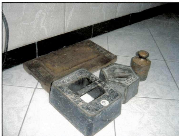
Figura 43 - Pesos Padronizados Usados Nos Testes do Equipamento
