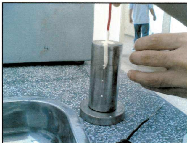
Figura 23 - Corpo de Prova Sendo Preenchido com Argamassa Expansiva
