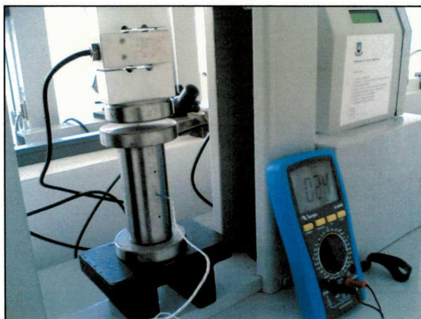
Figura 24 - Ensaio Preparado para Execução, com análise de Temperatura na Parte Central do Molde
