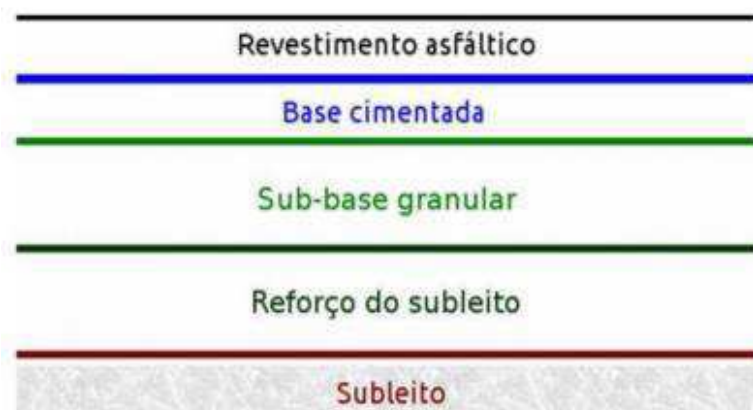
Figura 2 – Sistema de camadas do pavimento semi-rígido
