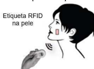
Figura 20 – Sistema de monitoramento da frequência respiratória do trabalho de Caccami et al. (2017).
