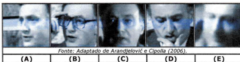
Figura 2.2 – Problemas em imagens de faces no tocante a variações de: (A) Pose; (B) Oclusão; (C) Iluminação; (D) Expressão facial; e (E) Condições de aquisição da imagem.
