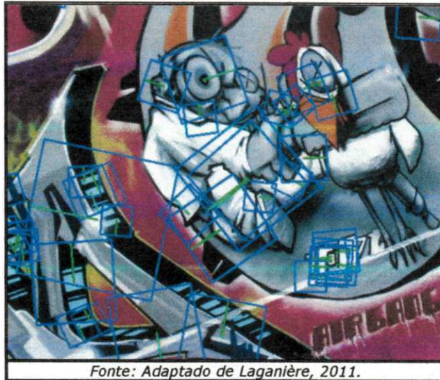
Figura 3.14 – Janelas do descritor. O tamanho da janela do descritor é 20 vezes a dimensão do ponto detectado e está orientada ao longo da direção dominante ilustrada em verde.
