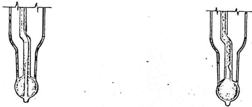
ESTRANGULAMENTO NO TUBO CAPILAR DE TERMÔMETROS DE MÁXIMA
