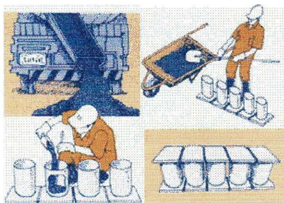
FIGURA 2.4 – Moldagem dos corpos-de-prova para ensaio de resistência.
