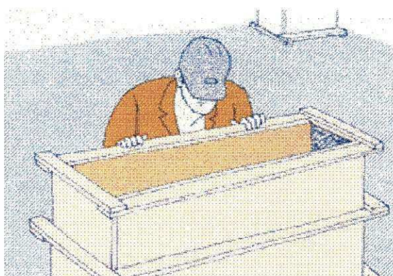
FIGURA 2.2 – Verificação das fôrmas.
