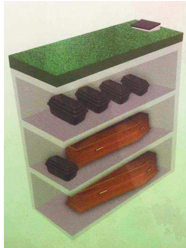
Figura 9: Estrutura interna dos jazigos
