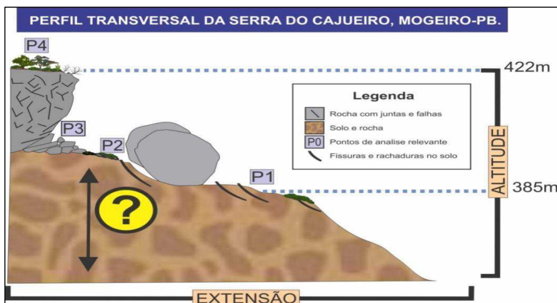
Figura 40 - Perfil transversal da Serra do Cajueiro. Produzido por COSTA (2018). Observação - O círculo de cor amarela com o sinal de ‘?’, designa-se, a NÃO identificação da profundidade e dimensões granulométricas do solo/rochas deslocadas/substrato.
