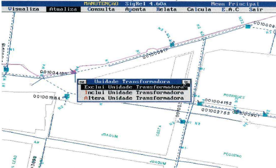
fig.3.3. (Módulo Atualiza/Unidade Transformadora)
