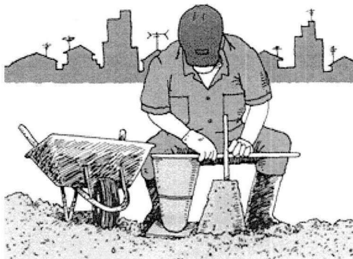
Execução do Slump-Test na Obra
