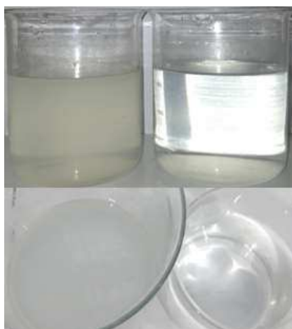
Figura III-10: Aspecto da água residuária antes e após o tratamento com 50 % EF e 25% CQ.
